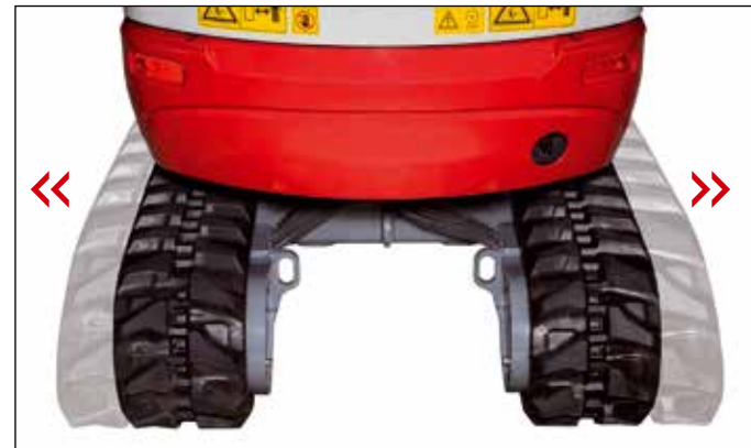
Tren de rodaje hidráulicamente ensanchable
