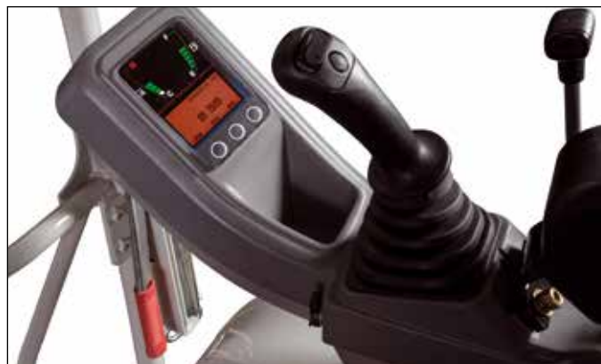
Panel de control con avisos acústicos y visuales en caso de fallo de funcionamiento; dirección proporcional del 2º circuito hidráulico desde el joystick derecho
