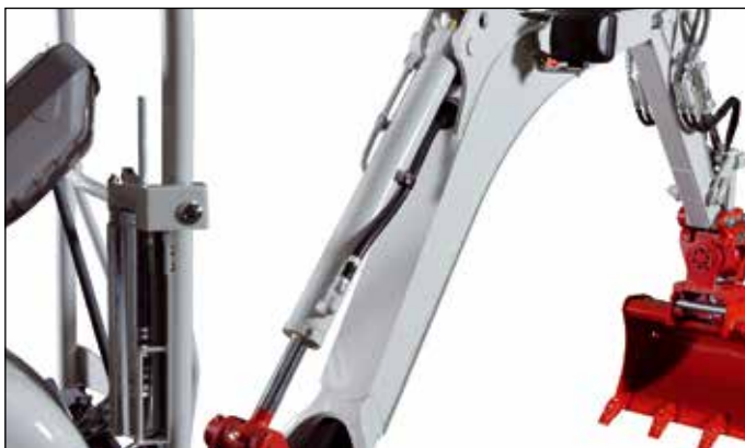
Botella de elevación en la parte posterior del brazo lo que proporciona una óptima protección contra daños
