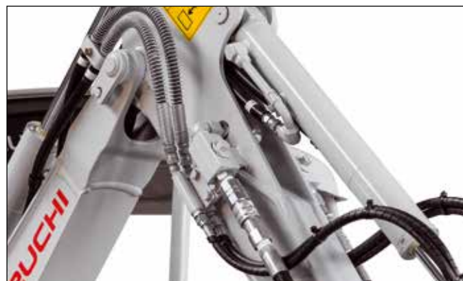
3 circuitos hidráulicos, 1 de ellos dirigido por potenciómetro
